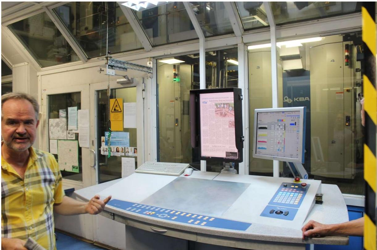
Steuerkabine für den Druck und die Drucküberwachung
