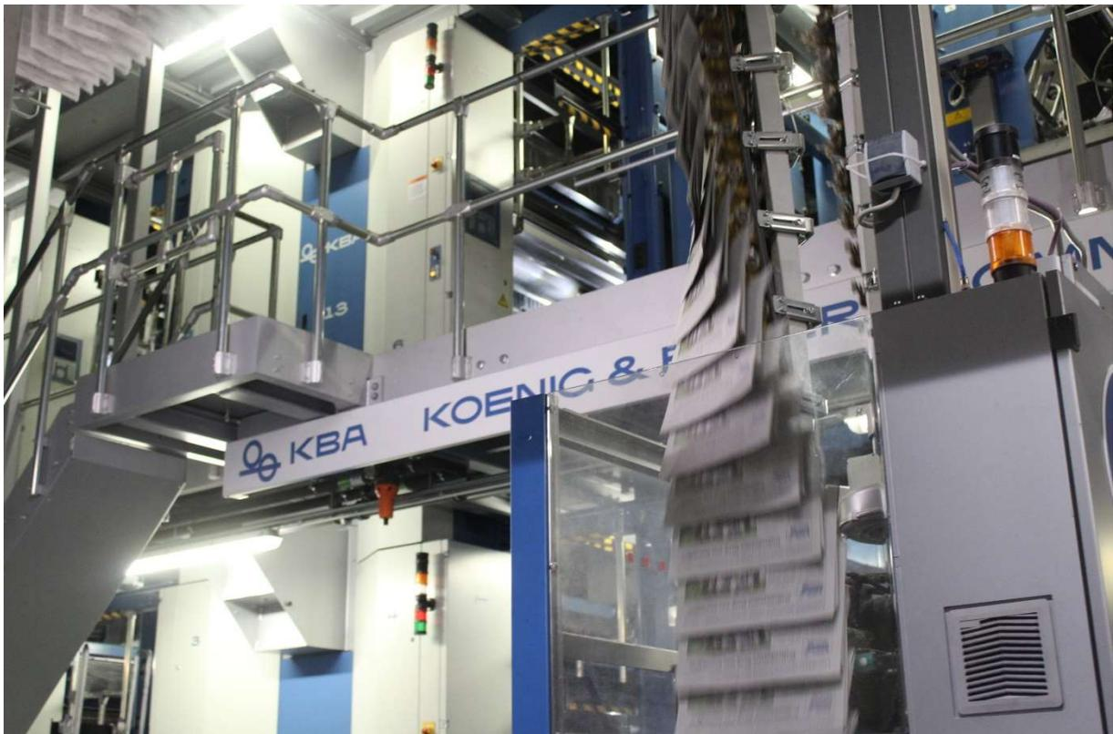
Hier kommen die gedruckten Zeitungsteile aus der Druckmaschine
